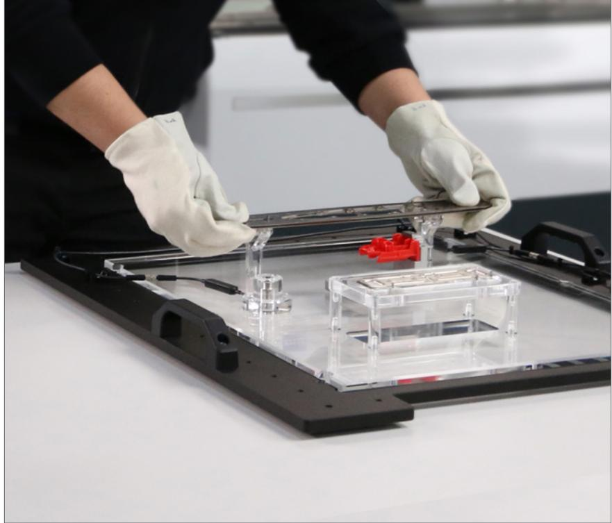
Der Messbereich von 500 x 400 mm kann komplett ausgeschöpft werden. Die Besonderheit ist die integrierte Temperaturschnittstelle, speziell für die ZEISS O-INSPECT 543.
