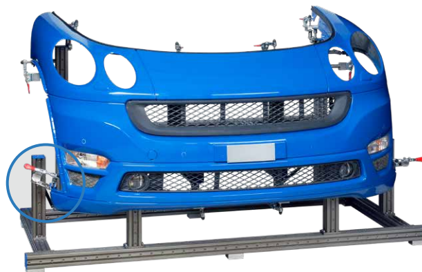
Dispositivo de perfil para sujetar piezas de carrocería
