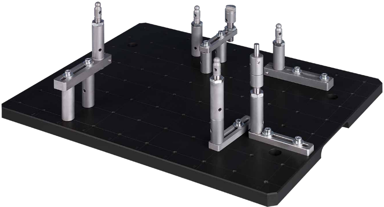
Dispositivo de sujeción para la fijación de una campana de acoplamiento
