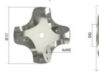
An dieser Sternaufnahme können bis zu vier Raumwinkelstücke aus dem ThermoFit Pro Produktprogramm befestigt werden. Die vier Aufnahmen sind in einem Winkel von 90° angeordnet. Dadurch können Sterntaster einfach und schnell aufgebaut werden.
