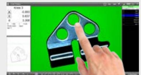
Einfache Messpunkterfassung durch Antippen des Elements im Live-Bild
