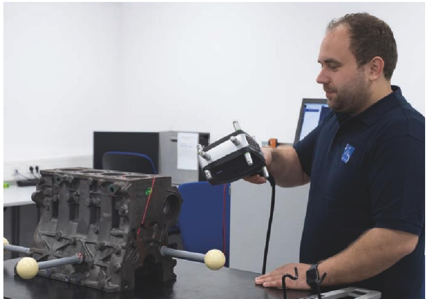
Christian Kunz usa ZEISS T-SCAN para digitalizar la superficie de un bloque de motor, que sirve como referencia para calibrar los robots.
