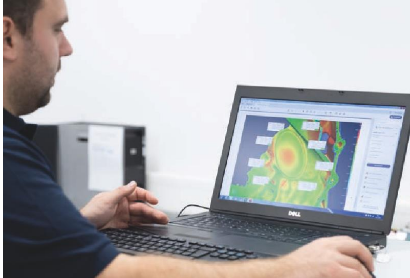
La comparación de colores falsos muestra de un vistazo en qué puntos hay un tamaño demasiado grande o demasiado pequeño.
