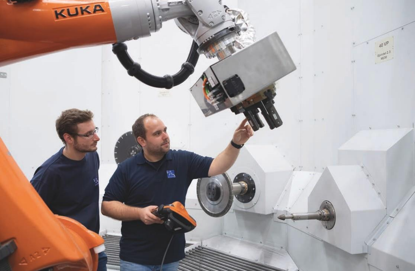
Christian Kunz (derecha) y Christian Haase inspeccionan las pinzas de un robot. Deben sostener fundiciones de motores pesados en las estaciones de procesamiento más adelante, que sobresalen de la pared a la derecha.
