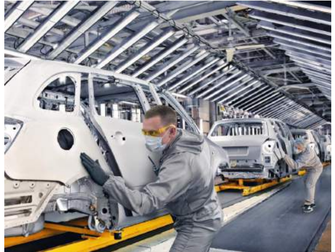
Inspección de superficies manual y visual (ejemplo)
