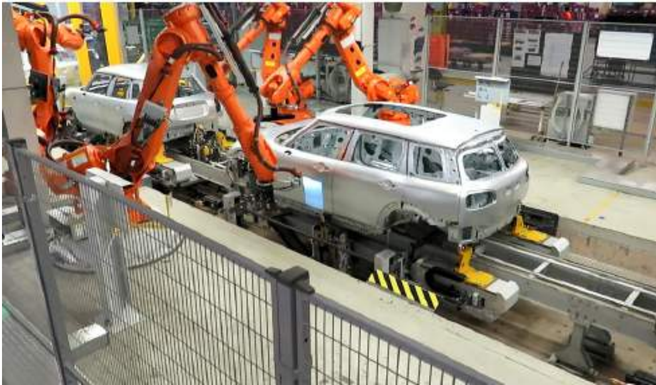
Inspección de superficies completamente automatizada con ZEISS ABIS II
